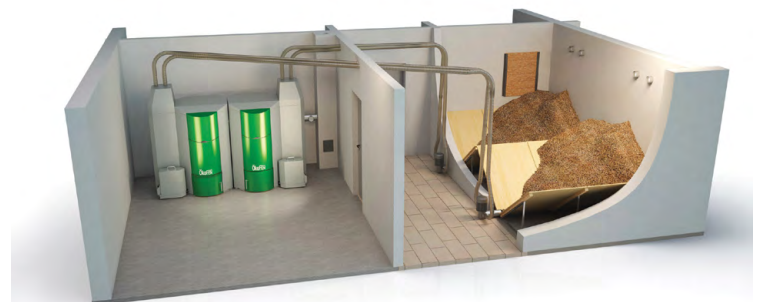
> 2 chaudières alimentées par 1 pièce de réserve
