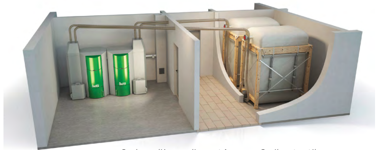
> 2 chaudières alimentées par 2 silos textiles
