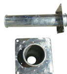
Tuyau de remplissage avec plaque de scellement extérieure. Diamètre 100 mm, longueur : 500 mm, plaque : 210 x 210 mm
