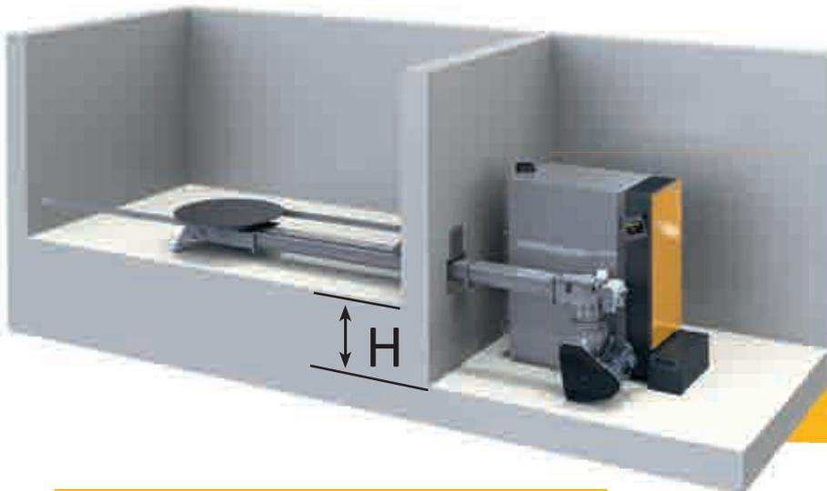
**Conseil ETA :** Pour une extraction horizontale, la différence de hauteur suivante entre le silo et le local de chauffage est nécessaire :
